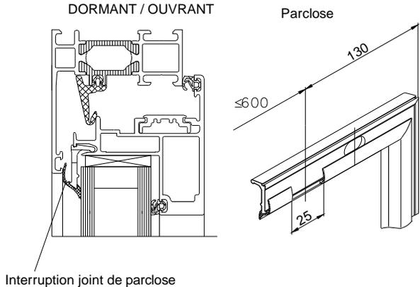
Option, pour un châssis au nu intérieur ou non exposé, usinage des lumières d'équilibrage de pression identique aux drainages
