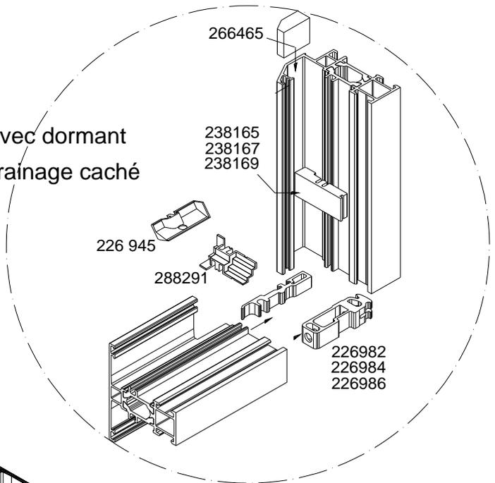
Assemblage traverse sur ouvrant
