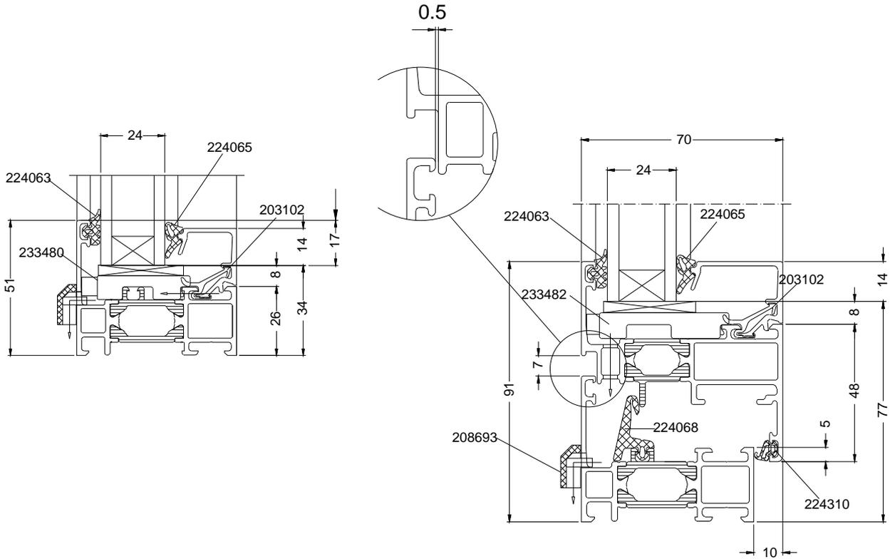
Coupe de principe sur dormant drainage caché
